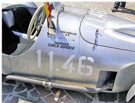
Un particolare della fiancata della Cisitalia Abarth 204 A con gli scarichi che fuoriescono dalla carrozzeria.
