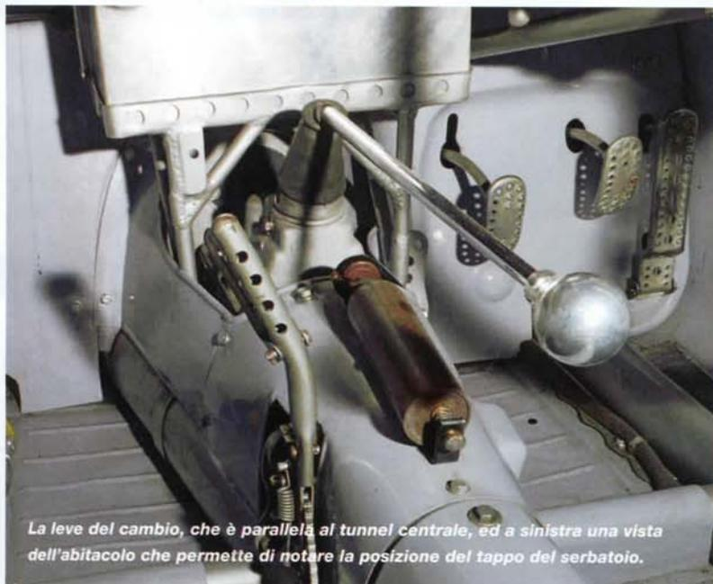
La leva del cambio, che è parallela al tunnel centrale, ed a sinistra una vista dell'abitacolo che permette di notare la posizione del tappo del serbatoio.
