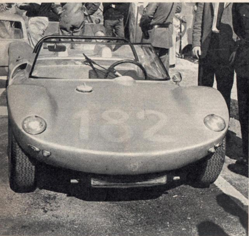
Il frontale del nuovo prototipo Porsche. Si notano i fari coricati in posizione di riposo
