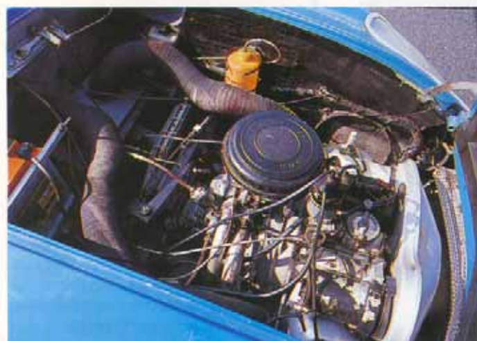
La DB monta un motore Panhard a due cilindri contrapposti.
