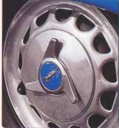
Copriruota in alluminio con finto gallettone al centro per la DB «750»
