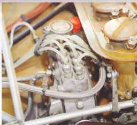
Sopra ed in basso a destra due viste dell'iniezione meccanica piazzata tra le due file di tromboncini. Ovviamente i numeri dipinti di rosso sopra ad ogni elemento indicano a quale cilindro si riferiscono. Sotto a sinistra un particolare dei tromboncini d'aspirazione che sono realizzati in vetroresina.
