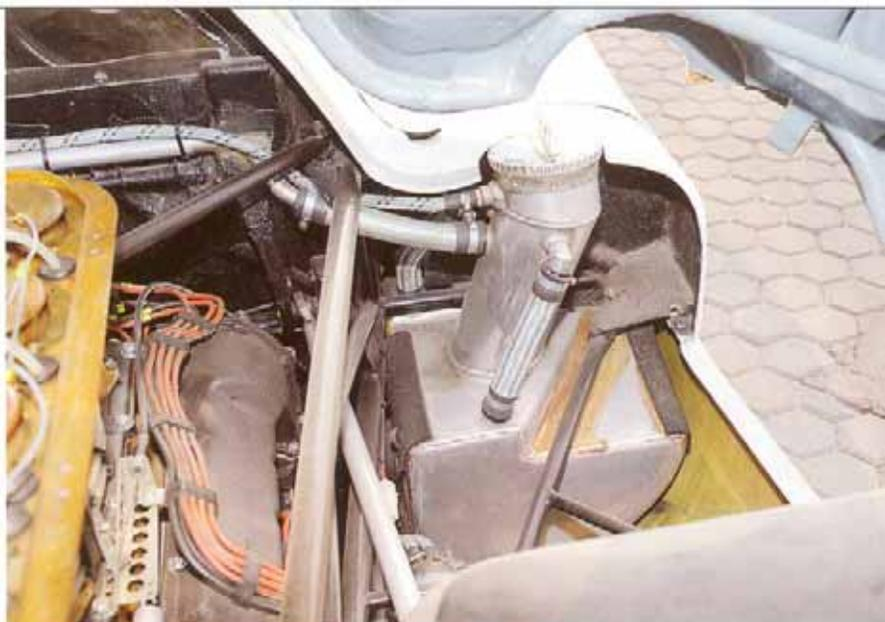
Sopra il serbatoio del carburante, e relativo bocchettone, piazzato sul lato destro della vettura. Sotto la cinghia di distribuzione. In basso un'immagine "tutta aperta" della vettura che scese in gara in una sola occasione, esattamente quarant'anni fa.
