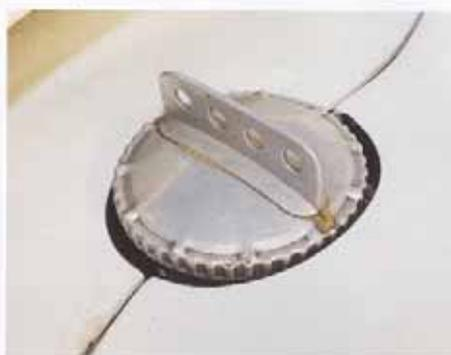
*In alto da sinistra in senso orario: la copertura del motore con le prese d'aria per i tromboncini, una particolare del lato destro della vettura, il tappo alleggerito del serbatoio ed il radiatore posizionato sul muso della Porsche 908.*
